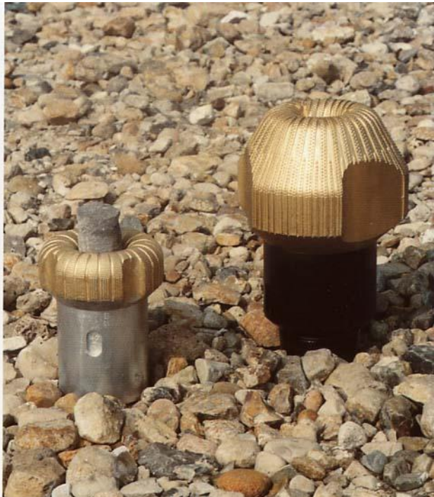
Der Diamant-Meissel. Er eignet sich für hartes Gestein. Der Bohrkopf ist mit künstlich hergestellten Diamanten besetzt. Er ist sehr teuer, zeigt aber einen relativ geringen Verschleiss.
