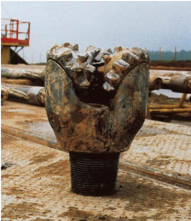
Der Rollen-Meissel. Er eignet sich zum Bohren in eher weichen Gesteinsarten. Auf drei radial angeordneten Rollen sind Zähne aus speziell hartem Stahl angebracht, die das Gestein zertrümmern.
